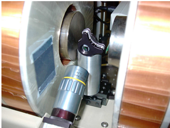
Figura 4.4: Sistema di posizionamento del campione tra le espansioni dell'elettromagnete
