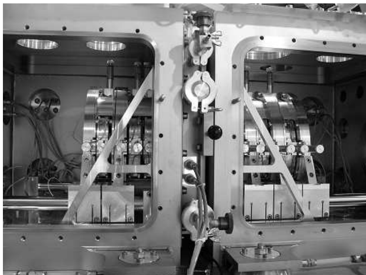
Figura 3.5: Foto del TwinMic: si notano le due camere principali contenenti i moduli semovibili e al centro la camera riservata al supporto per il campione. Quest'ultima può essere in comunicazione o isolata dal resto dello strumento. Il fascio di raggi X arriva da destra, incide sul campione al centro ed esce a sinistra, dove è installato il CCD
