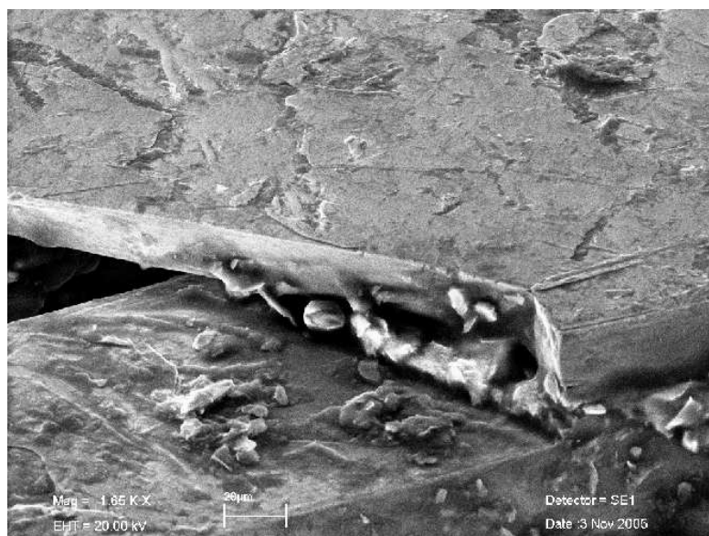
FIGURA 2.3: Ingrandimento della sezione. Il blocco superiore è quello superficiale che appoggia su un blocco parallelo ad esso. La magnificazione è 1650X.
