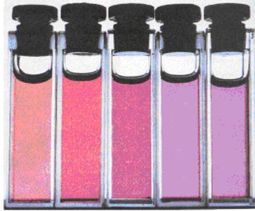
Figura 4.8: nanoparticelle d'oro di diametro 16nm inserite in soluzioni colloidali realizzate con diversi solventi. S.Underwood, P.Mulvanay, Langmuir 1994.
