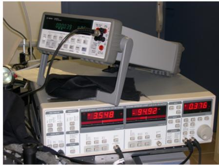
Figura 5.13: amplificatore lock-in utilizzato in questo set up sperimentale. Sul display a destra si può osservare la frequenza impostata per la vibrazione del campione a 1,5kHz, corrispondente a 0,376V.
